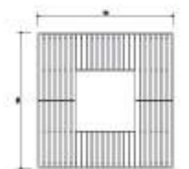
Grille d'arbre ligne Synergie de chez UNIVERS & CITE en acier galvanisé, 120x120cm, composée de deux demi-éléments
